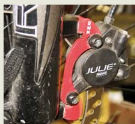
Zkombinovat IS třmen a PM uchycení znamená sáhnout po redukci a nasadit větší kotouč, zde v případě ocelové redukce, kde dojde ke zvětšení průměru o 20-25 mm.
