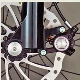
Starší modely brzd Magura (2006) byly stejně jako většina dalších určeny pro IS standard. Třmen tak bylo možné vystředit pouze do boků přidáním podložek či ubráním materiálu. Navíc pro změnu průměru kotouče byla třeba speciální, hodně masivní redukce.
