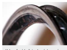
Vybroušené bočnice hrozí zborcením stěny ráfku
