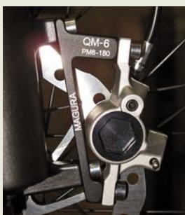
Postmount třmen Magura vyžaduje pro použití většího průměru kotouče hodně vysokou redukci. Třmen lze nastavit pouze do stran posuvem v otvorech pro šrouby.
