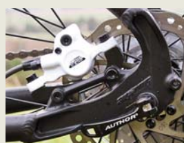
Třmen brzdy dnes může být uchycen i na vnitřní straně zadní stavby, nicméně pro standardy uchycení a redukce platí totéž co pro klasiku. Pouze nasazení většího kotouče může být omezeno prostorem mezi rameny zadní stavby.
