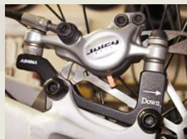
Značka Avid přišla jako první u svých PM třmenů s kloubovými podložkami pro uchycení jak napřímo, tak přes redukci. Díky tomu lze nastavit třmen ve více rovinách.
