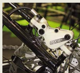
Cannondale, nově i BMC, Ghost a další nabízejí u některých biků zadní uchycení PM kvůli snížení hmotnosti a navýšení tuhosti zakomponováním šroubů do rámu.
