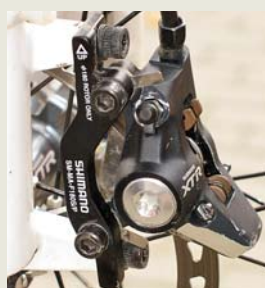
Shimano XTR je sice špičkou, ovšem i u něj může dojít ke komplikacím. Standard IS značně omezuje variabilitu nastavení třmene, zde v kombinaci s redukcí na PM jsou pod šrouby jasně patrné plechové vymezovací podložky pro boční vyštěpení.
